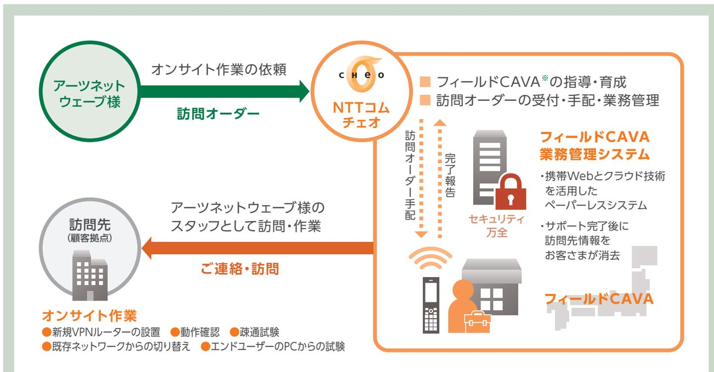
アーツネットワーク様のスタッフとして、フィールドCAVA (F-CAVA)<sup>※</sup>が法人顧客の事業所を訪問し、ネットワークをVPN化する作業を実施している(新規VPNルーターの設置、動作確認、疎通試験、既存ネットワークからの切り替え、エンドユーザー様のPCからの試験)。
